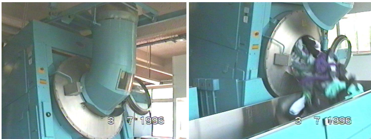
Figures b9 et b10 : Chargement-déchargement d'une laveuse
