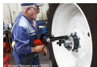
(c) Serrage d'une roue de tracteur à l'aide d'une visseuse pneumatique
