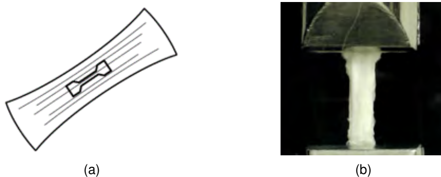
FIGURE 2.11 – (a) Découpe d'une éprouvette dans un prélèvement de ligament du genou ; (b) essai de traction réalisé sur cette éprouvette (Ristaniemi et al., 2018)
